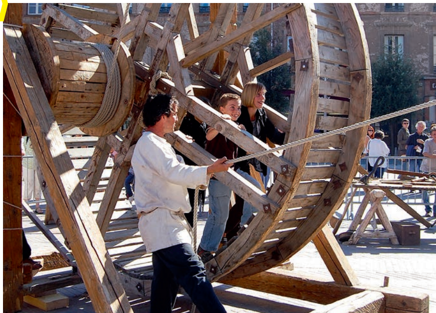
Reconstitution, place de la Pile, d'une roue utilisée au Moyen-Âge pour lever des charges lourdes. Un bon moyen de parler histoire de manière concrète.
